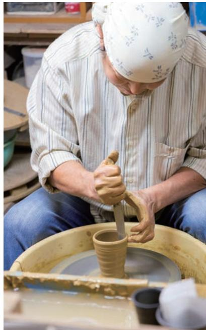
據說珠洲燒汲取了古墳時代中期從大陸傳入的須惠器的製作手法。使用富含鐵質的珠洲土製作大型器物的時候，多會採用將黏土條盤捲塑形，並拍打以增強坯體的強度的技法。現代的珠洲燒陶匠們也使用相同的技術，中型或小型器具則多用陶輪拉坯，將坯體用1200度以上的高溫烘烤，透過稱為「燻燒」的獨特方法，利用燒製過程後半氧氣不足的火焰燒成陶器。珠洲燒不使用釉藥，在高溫之下融化的柴火的灰燼，就成了天然的釉藥。經過幾天時間的燒製，坯體已經緊緻得足以防止漏水。並且透或燻燒（碳化燒成）手法，染上一層黑灰色的沉穩光澤。
